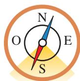
**ORIENTATION :** Les panneaux doivent être orientés entre Sud-Est et Sud-Ouest et doivent se trouver à un endroit exempt d'ombres portées pendant au moins 6 h par jour, soit 3 h avant le zénith et 3 h après.
